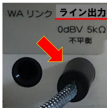
オーディオコードとスピーカーの接続（ ライン出力 にピンジャックを挿入）
