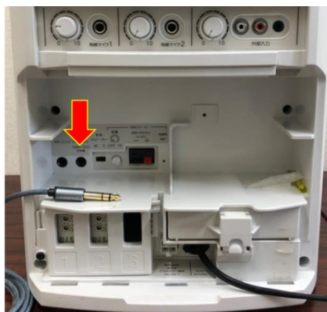
オーディオコードとスピーカーの接続（ ライン出力 にピンジャックを挿入）
